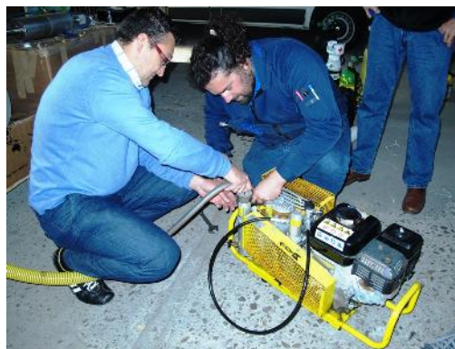
16. Nuevo compresor para cargar gas
